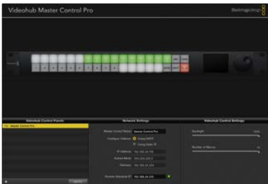
Blackmagic Videohub Hardware Panel Setupは、ネットワーク上のVideohubコントロールパネルを自動的に検索
