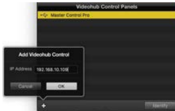
IPアドレスを入力することで「Videohub Control Panels」のリストに、Videohubコントロールパネルをマニュアルで追加可能
