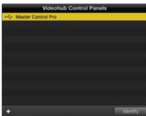
イーサネット/USB接続されているすべてのコントロールユニットが「Videohub Control Panels」ウィンドウにリストアップされ、それぞれのアイコンが表示されます。
