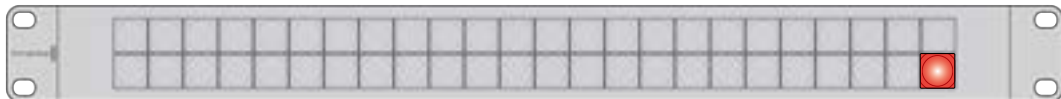
カットバスコントローラーとしてコンフィギュレーションされ、TAKEボタンが有効になっているVideohub Smart Control Pro
