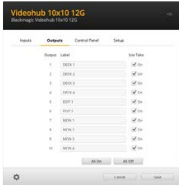
カットバスモードは「TAKE」ボタンを使用せずにルーティングを変更可能
